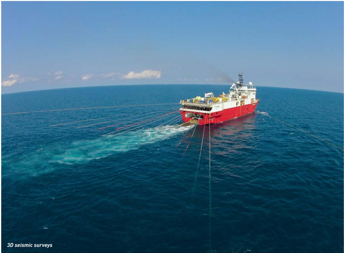
3D seismic surveys
